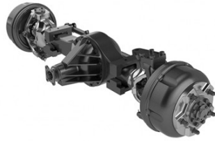
3.5T FRONT AXLE ASS'Y - 전륜 바퀴에 동력을 전달 - 4X4 주행을 통한 구동력 향상
