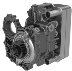
상용트럭 리타더 - 로터/스테이터에서의 유체저항으로 제동력을 발생하여 내리막길에서의 브레이크 밀링 방지
